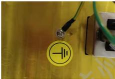
此处为保护接地点，防止电流外泄导致触电。
